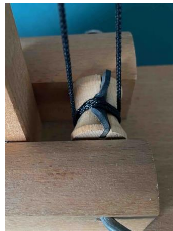
rubber om de kabels te spannen
