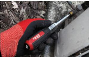
Extractor de Núcleo de Válvula Schrader®
