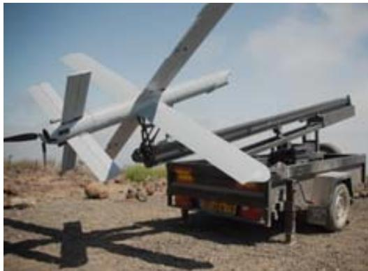
Figura 2 – Exemplo de sistema aéreo não-tripulado suicida (*loitering munition*)
