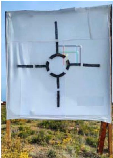
Figura 1 – Determinação da distância dos impactos ao centro do alvo
