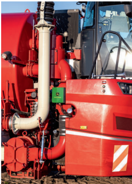
Unscheinbar hängt die grüne Box mit dem NIR-Sensor an der Seite. Wert: rund 20.000 Euro.
