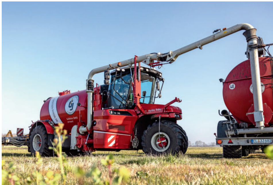
Egal, welche Gülle am Feldrand angeliefert wird, der Gülletrac misst die Inhaltsstoffe beim Ausbringen und düngt nur die gewünschte Nährstoffmenge, auf Wunsch auch teilflächenspezifisch.
