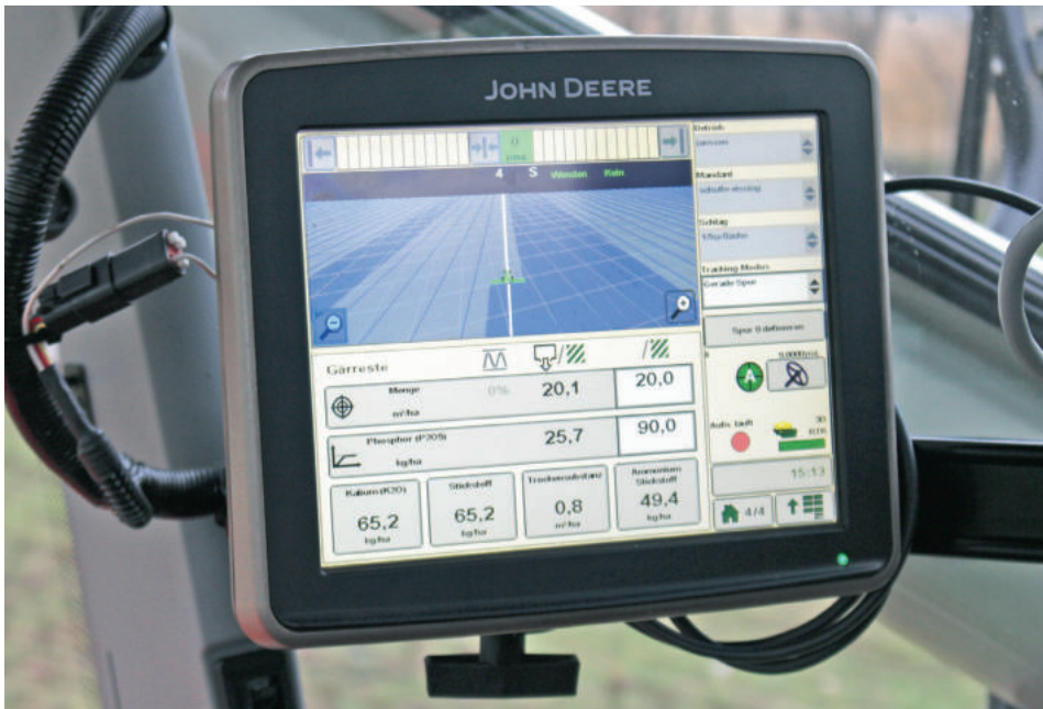
Das GreenStar-Display zeigt die Messergebnisse für Kalium, Stickstoff, Trockensubstanz und Ammonium-Stickstoff. Neben den Echtzeitwerten der Güllendaten lassen sich auch Mittelwerte darstellen.
