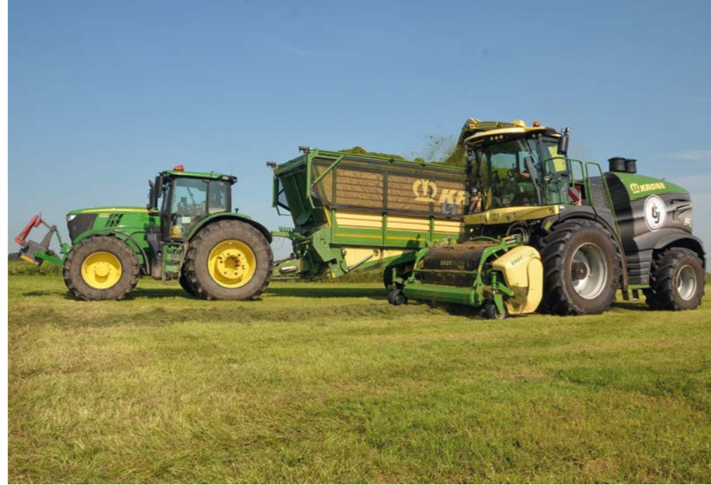
Auch auf dem Feldhäcksler kommt NIR-Sensorik zur Ertragskartierung und jetzt auch zur Inhaltsstoffmessung im Mais zum Einsatz. Ingo Janssen kann seinen Kunden jetzt genau sagen, wieviel Mais er mit welchem Energiegehalt ins Silo gelegt hat. Im Detailbild ist die Ertragskartierung zu sehen.
