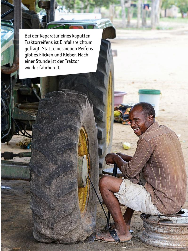
Bei der Reparatur eines kaputten Traktorreifens ist Einfallsreichtum gefragt. Statt eines neuen Reifens gibt es Flicker und Kleber. Nach einer Stunde ist der Traktor wieder fahrbereit.
