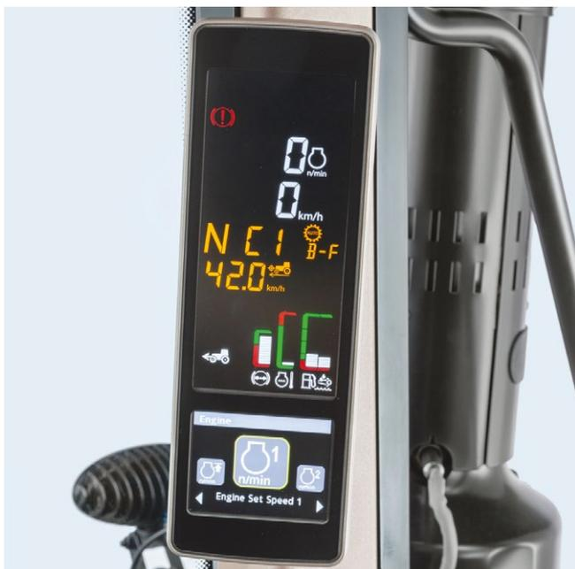
AutoTrac Basisvariante integriert in das Eckpfostendisplay
