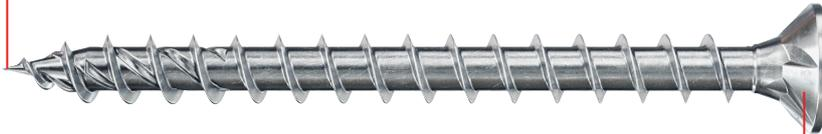
Die Unterkopfgeometrie mit optimiertem Doppelkonus und Frästaschen sorgen für weniger aufgerissene Holzoberflächen und weniger Beschädigungen auf Metallbauteilen. Für eine **bessere Optik und Haptik der Oberflächen**.
