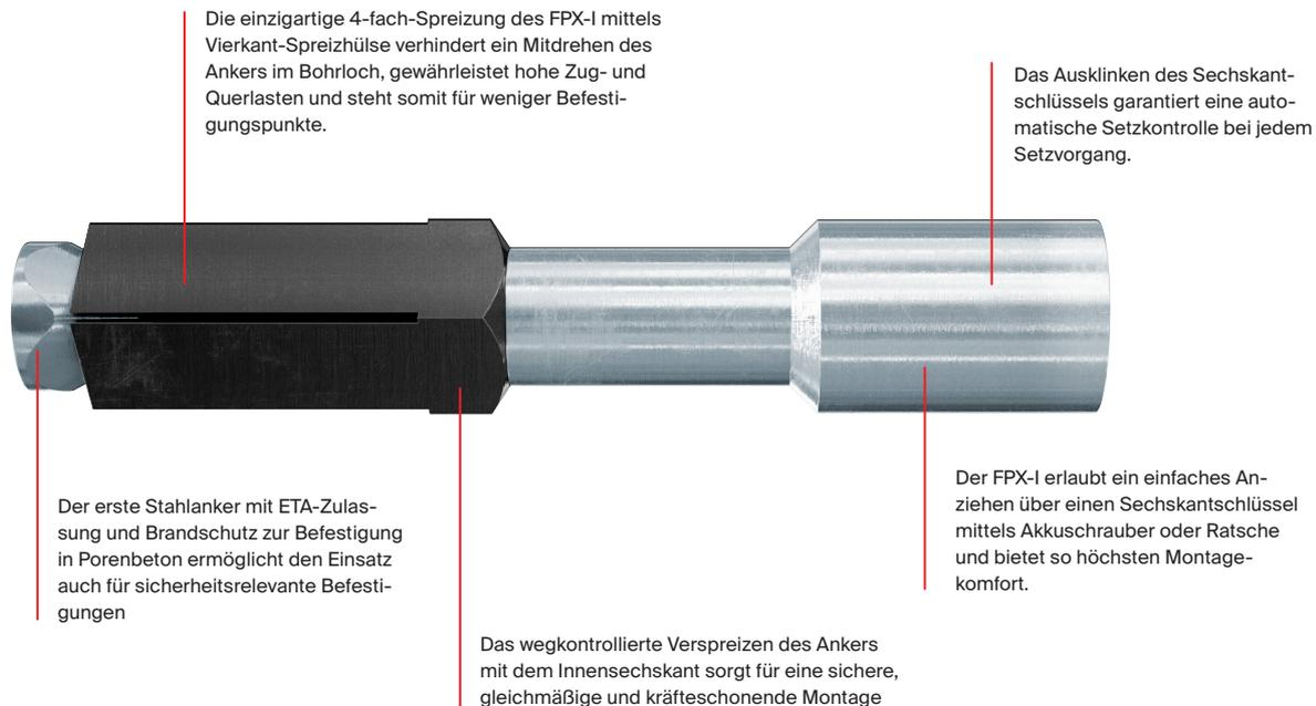
Die einzigartige 4-fach-Spreizung des FPX-I mittels Vierkant-Sprezhülse verhindert ein Mitdrehen des Ankers im Bohrloch, gewährleistet hohe Zug- und Querlasten und steht somit für weniger Befestigungspunkte.
