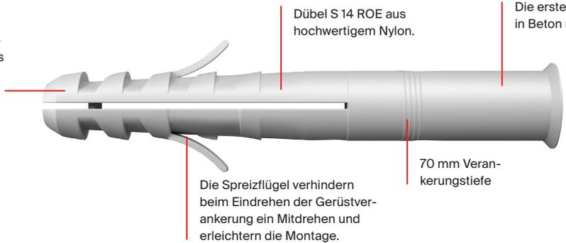
Der Dübel spreizt in zwei Richtungen auf. Durch Drehen des Dübels können die Spreizkräfte gezielt parallel zum Baustoffrand in den Baustoff eingeleitet werden, wodurch auch randnahe Befestigungen möglich sind.
