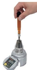
BMRD Drehmomentüberprüfung mit BTGE-G und Messstand.
