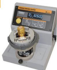
TDT600CN3-G mit Prüfaufsatz (Modell: STA)
