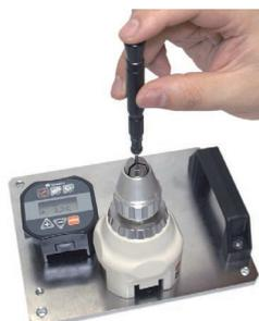
AMRD Drehmomentüberwachung mit ATGE-G und Messstand.
