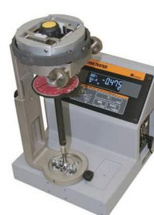
Abbildung einer Kalibrierung der Drehmomentschraubendreher RTD links und FTD rechts mit TDT3-G
