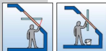
Il sistema basculante permette di regolare l'apertura della finestra in qualsiasi posizione consentendo una perfetta aereazione ed un continuo ricambio dell'aria. La rotazione del battente a 130° agevola inoltre una facile pulizia del vetro esterno.
