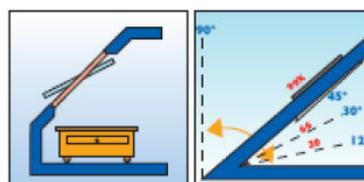
La finestra mod. "B" apertura basculante, può essere installata su tetti con pendenza a partire dai 12°.
