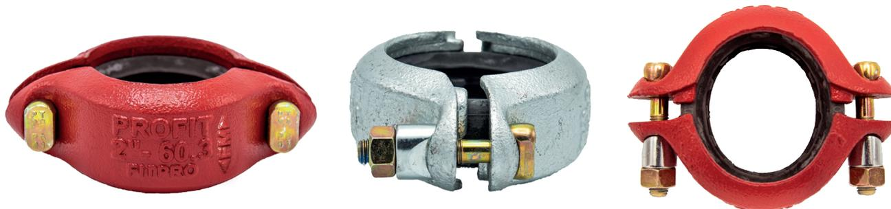
Fitpro® est un raccord conçu pour réaliser des connexions rigides rapides dans les systèmes de tuyauterie de sprinklers sous air et sous eau. Il s'utilise uniquement avec des tuyauteries rainurées et il est prêt à être installé. **Conception brevetée.**
