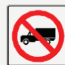
SR-32 Prohibido el paso a vehículos pesados
