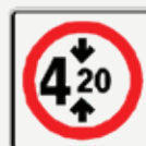
SR-15 Altura libre restringida
