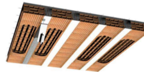
Passivazione dell'armatura e ripristino del materiale cementizio di distacco dei travetti
