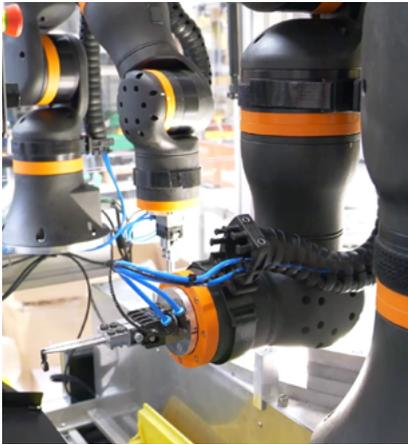
Er bedruckt Halbzeuge an Extrusionsanlagen und unterstützt beim Bohren von Gewinden in Gelenkköpfe aus Hochleistungskunststoff.
