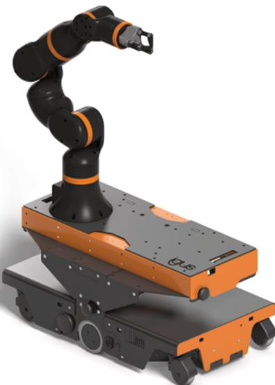
Der autonome mobile Roboter ReBeL Move von igus eignet sich ideal für den innerbetrieblichen Transport. Mit einer Traglast von 50 kg und einem Zuggewicht von bis zu 100 kg ist er leistungsstark und flexibel einsetzbar – etwa für den Material- und Werkzeugtransport zu Arbeitsplätzen oder Maschinen. Die Einrichtung erfolgt schnell und unkompliziert über eine intuitive App.
