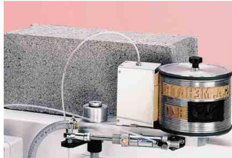
Questo intervallo è in funzione della velocità del convogliatore. Il rullo inchiostrante è mantenuto in pressione sull'oggetto da marcare tramite un cilindro ad aria compressa (il quale necessita un'alimentazione a 6 bar, secca e senza polvere).
