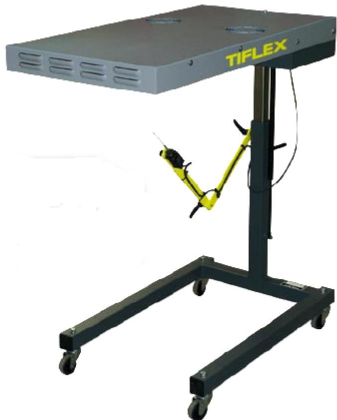
La Flash è un asciugatore intermedi per gli inchiostri tessili. E' costituito da emittitori infrarossi a onde corte, è costituito da un elemento riscaldante ed un supporto. E' disponibile in due formati: 40 x 40 cm e 40 x 60 cm.
