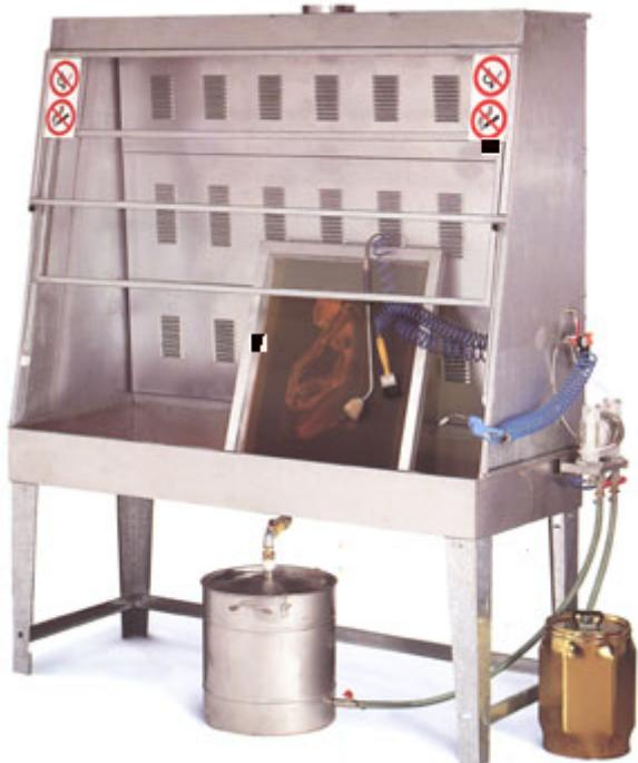
Questa attrezzatura è utilizzata per il lavaggio dei telai garantendo all'operatore ottime condizioni di sicurezza, salvaguardando l'ambiente di lavoro e economizzando tutto il ciclo di lavoro filtrando e riutilizzando lo stesso solvente. Non necessita di alcun attacco alla corrente elettrica ma solamente di aria compressa.
