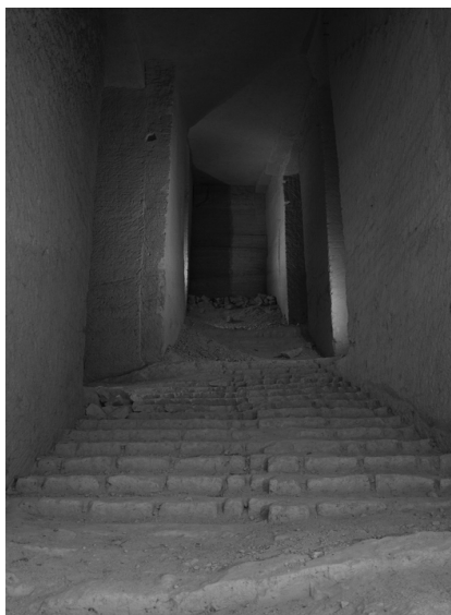
Figura 4a-4b. a: Gradinata con conci e tagli già preparati (Cave Angelino), b: "Casinot" ospitante motore e argano (Cave Campagnola).
