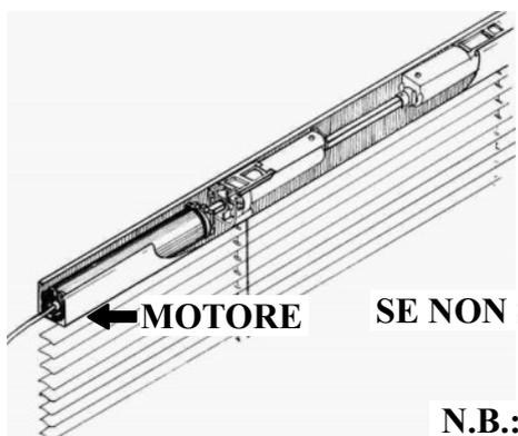
DOTATA DI SISTEMA DI ORIENTAMENTO E SOLLEVAMENTO MOTORIZZATO A 24 VOLT E FINECORSO MECCANICO, AZIONABILE TRAMITE PULSANTE ESTERNO OPPURE TRAMITE TELECOMANDO
