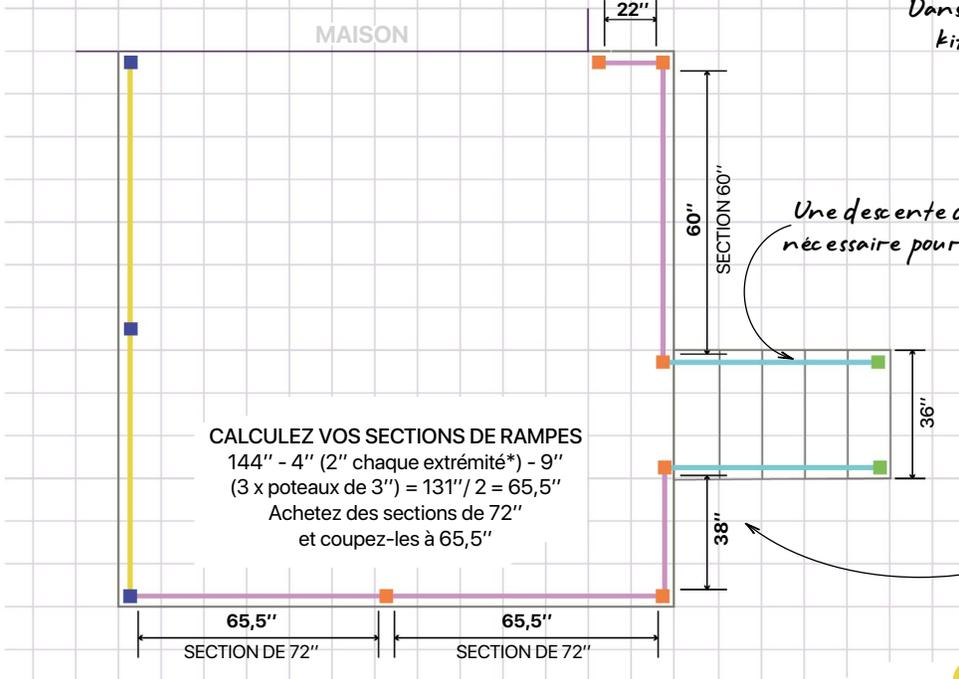
Éviter les pertes en utilisant une retaille d'une autre section coupée, comme dans notre simulation.
