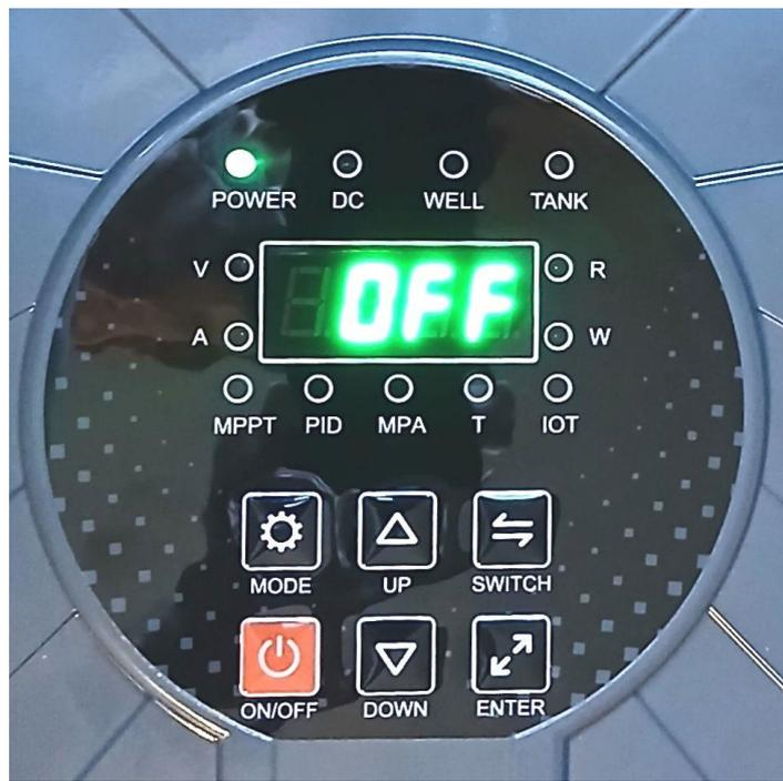
La foto è relativa al pannello del controller alimentato in AC e pronto per la marcia. Le due segnalazioni a led "WELL" e "TANK" devono essere spente.
