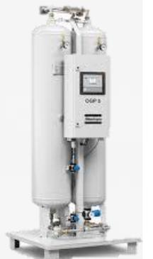
(\*)OGP – Generador de Oxígeno O2 El equipo Atlas Copco OGP es un generador de oxígeno estándar de Atlas Copco basado en la tecnología de adsorción por cambio de presión para la producción de oxígeno en el punto de uso con una pureza de hasta el 95 %
