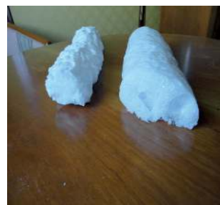
Difetti di compattezza dovuti a miscelazione non corretta dei componenti.
