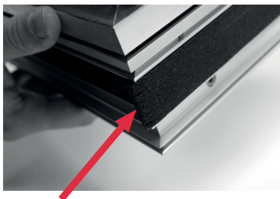
Per garantire una perfetta tenuta il nastro termoespandente applicato sui montanti deve sporgere rispetto al vertice inferiore di almeno 2mm.
