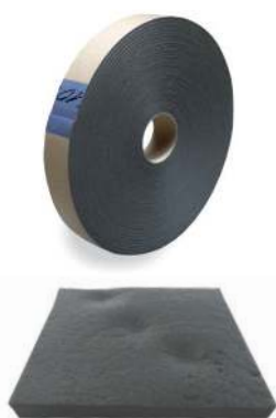
Il nastro in schiuma di PVC AGP 5037 è assolutamente impermeabile, soffice e comprimibile. Per questa ragione si deforma facilmente sotto il peso della finestra favorendo il massimo contatto tra il nastro e la traversa inferiore del telaio e quindi l'impermeabilità all'acqua del sistema.
