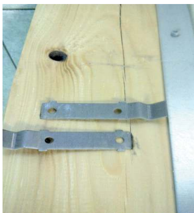
Le spalle in legno massiccio non garantiscono una tenuta standardizzabile delle viti di ancoraggio.
