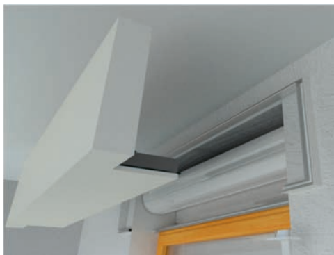
Soluzione PosaClima per la coibentazione interna del vecchio cassonetto
