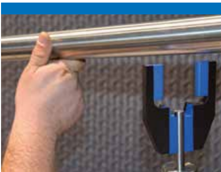
Handlauf in die Vorrichtung einsetzen. Infilare il corrimano nella dima.
