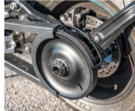
De riemaandrijving zorgt wel voor iets meer aandrijfgeluiden
