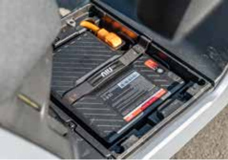
De accu zit onder de treeplank
