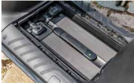
De twee accu's zitten onder de treeplank
