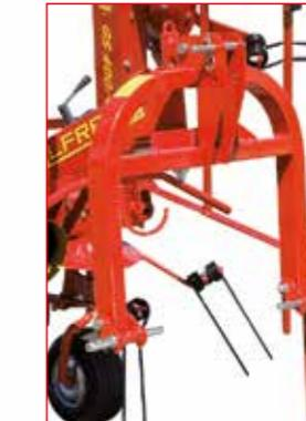
**L'attacco a tre punti snodato,** conferisce mobilità e agilità anche nelle curve, il foraggio viene depositato nella scia della macchina, nelle manovre di sollevamento, la macchina ritorna automaticamente in asse con il trattore.
