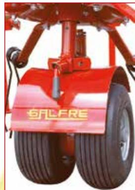
**Dispositivo di spandimento laterale.** Le ruote sono posizionabili manualmente tramite una manovella. Sui modelli PGS 800, PGS 730, PGS 650, PGS 550, la posizione viene ottenuta anche idraulicamente.
