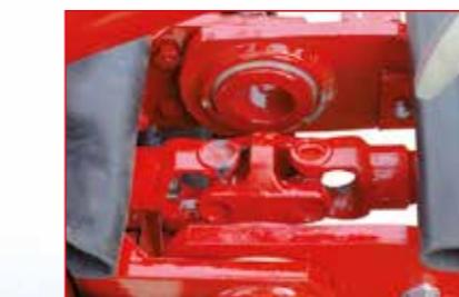
**Doppio giunto.** Funzionamento sicuro e robusto, questo giunto a doppia crociera garantisce sicurezza in fase di chiusura idraulica dei giranti esterni. Ottima articolazione per un perfetto adeguamento ai dislivelli del terreno.
