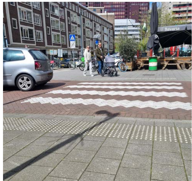
Figuur 4.21 Waarschuwingsmarkering bij oversteekplaats (TG-lining)
