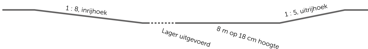
Figuur 6.16 Principe van een haltehaven
