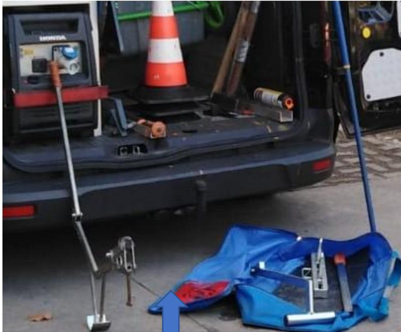
ALZA CHIUSINI DOTATO DI VARI GANCI PER APERTURA POZZETTI DI DIVERSO TIPO
