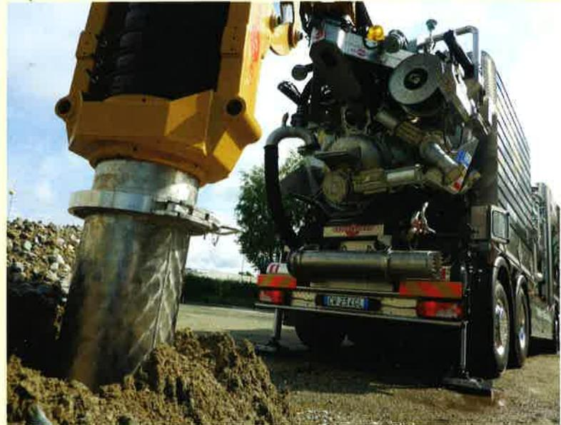
**CAP BORA EXCAVATOR ATEX-ADR** è la massima espressione tecnologica dell'aspirazione sottovuoto e del trasporto pneumatico di materiali polverosi e liquidi anche pericolosi ed esplosivi.
