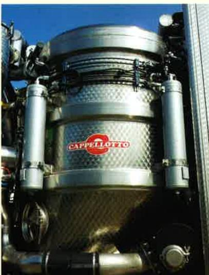
Vano filtri aria autopulente con ampia apertura superiore per la manutenzione ordinaria
