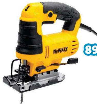
Design confortável e ergonómico. Potente motor de 650W. Dial e gatilho de velocidade variável fornece maior controle no corte de todos os materiais. Acção pendular de 3 posições para maior rapidez de corte, qualidade de acabamento e durabilidade da lâmina. Base ajustável sem ferramentas e capacidade de bisel até 45° em ambos os lados. Mudança da lâmina sem ferramentas. Punho de borracha, reduz a vibração e oferece maior conforto ao usuário
