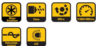
Motor Brushless (sem escovas de carvão). Alto torque de 65Nm para uso pesado. Caixa de engrenagem com duas velocidades. Áreas emborrachadas. Encaixe metálico reforçado • Spindle lock automatico. Velocidade variavel e reversivel. Luz LED.
