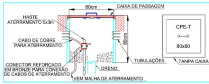
CAIXA DE PASSAGEM ELÉTRICA COM ATERRAMENTO (CPE-T) SEM ESCALA
