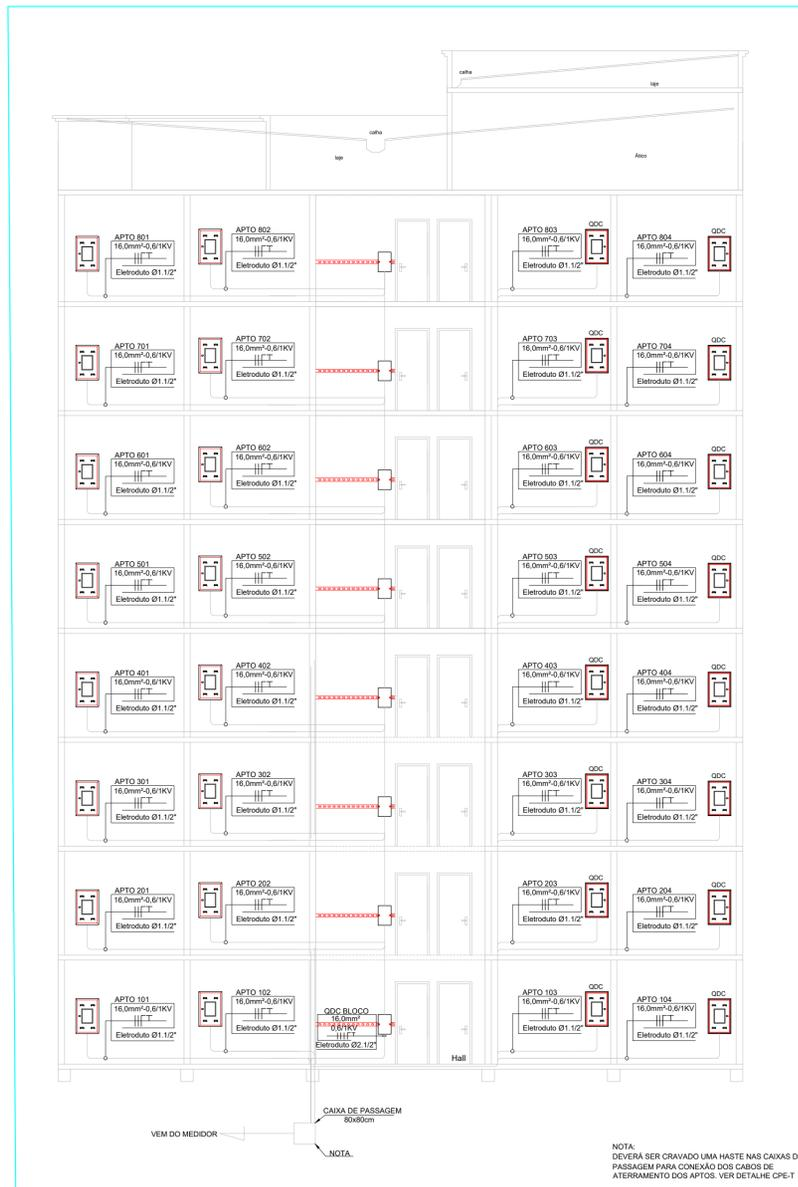
CORTE ILUSTRATIVO PRUMADA ELÉTRICA TORRE 01 E 02 SEM ESCALA
