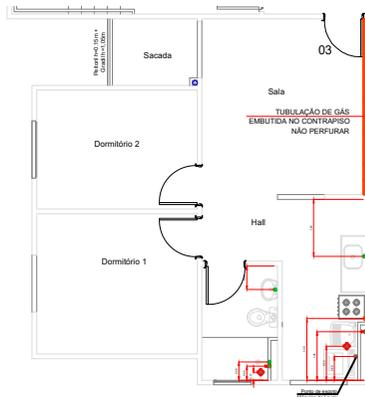
PLANTA DE PONTOS - PAVIMENTO TIPO
