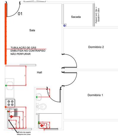
PLANTA DE PONTOS - PAVIMENTO TIPO
