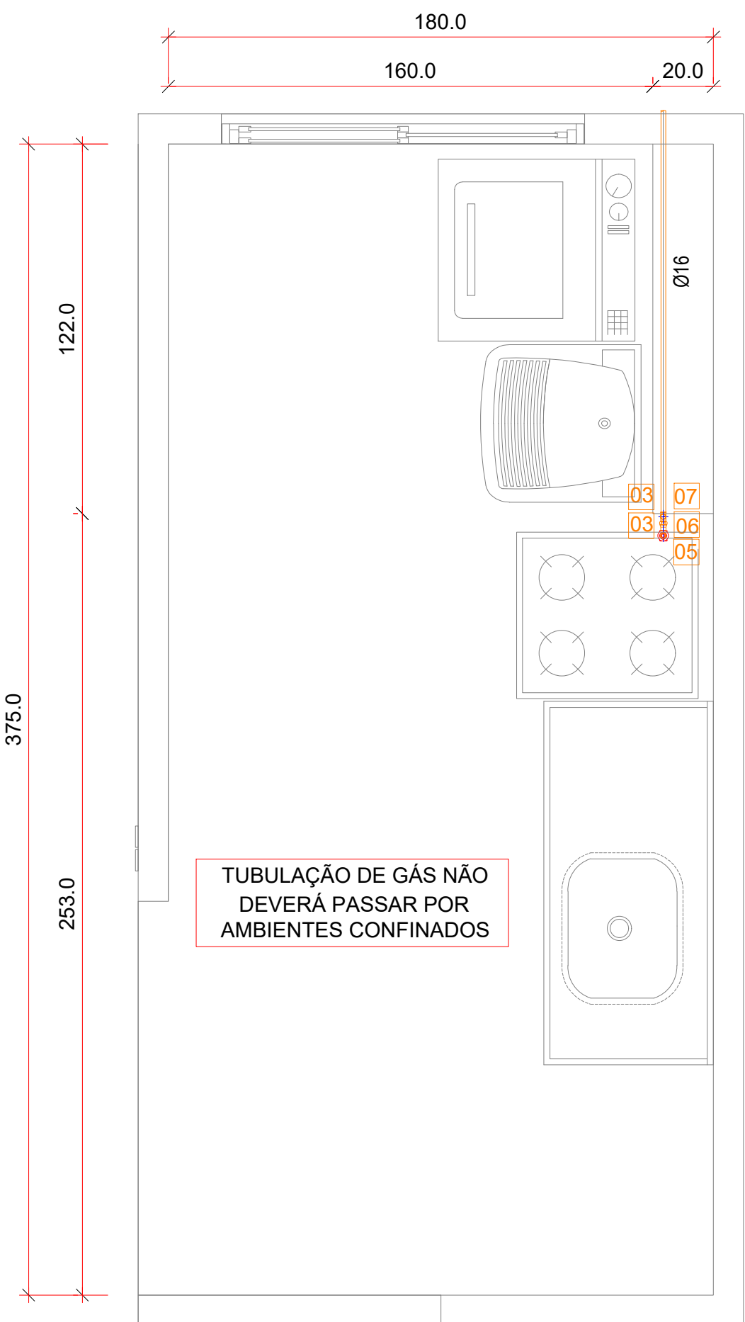
DET 1 (64x) DETALHE GÁS DA COZINHA ESCALA 1:25
