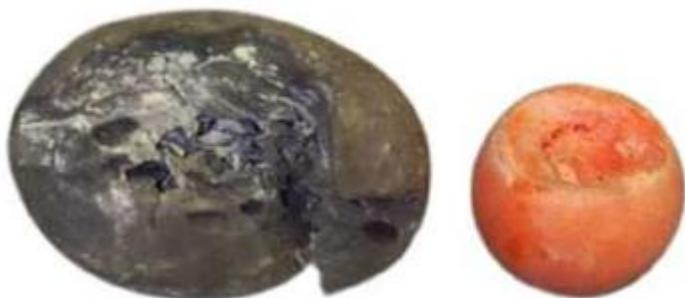
Sfere della valvola di ritegno deformate o masticate per incompatibilità con il fluido.
