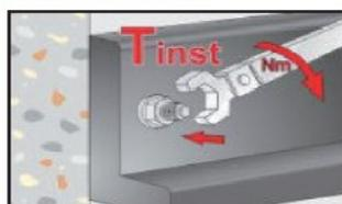
1) Il fissaggio passante è consentito (posizionare l'elemento da fissare prima di inserire l'ancorante nel foro)
