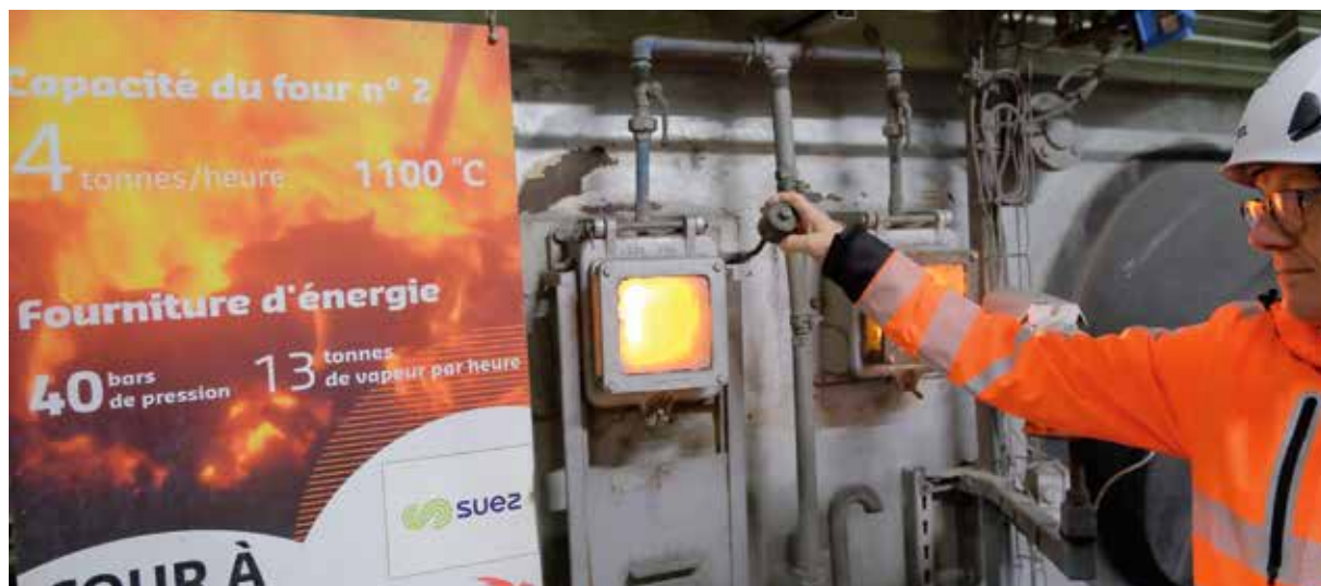
▲ Le four N°2 atteint une température de 1 100°C.
