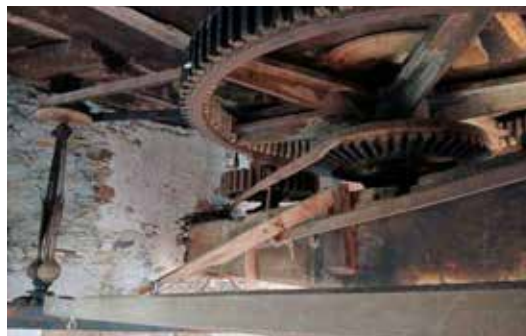
▲ À tous les étages, d'impressionnants rouages, tous d'origine, permettent d'activer et de régler le moulin.
