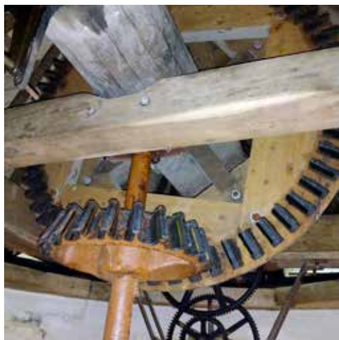
▲ Taillé dans un chêne, l'arbre moteur va être changé, grâce au Loto du Patrimoine.
