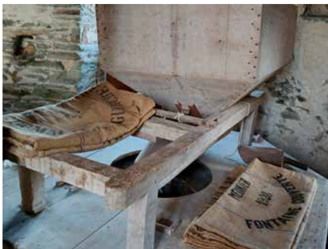
▲ Entre deux pierres dont l'écart se règle au millimètre, les céréales (aujourd'hui du sarrasin), sont écrasées.
