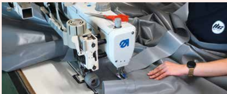
▲ La couture des brise-vent ou bâches de fermeture est réalisée sur plusieurs dizaines de mètres.
