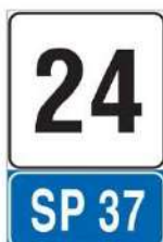
FIG. 267 ART. 129 PROGRESSIVA DISTANZIOMETRICA PER STRADA PROVINCIALE
