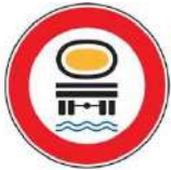
FIG. 64/b ART. 117 TRANSITO VIETATO AI VEICOLI CHE TRASPORTANO PRODOTTI SUSCETTIBILI DI CONTAMINARE L'ACQUA
