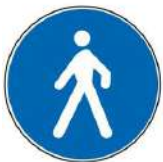
FIG. 88 ART. 122 PERCORSO PEDONALE
