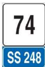
FIG. 266 ART. 129 PROGRESSIVA DISTANZIOMETRICA PER STRADA STATALE
