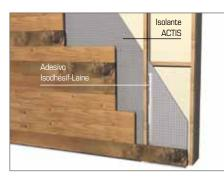
Lasciare una camera d'aria non inferiore a 20 mm da entrambi i lati dell'isolante
