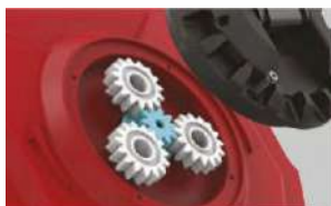
Los engranes planetarios evitan el barrido
