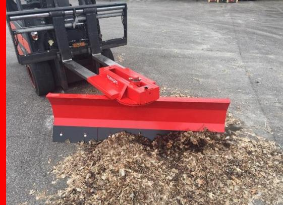
Das GT-FL ist mit 2,5 m und 3 m Arbeitsbreite mit EURO-, SMS- oder Dreipunkt-Aufhängung, Kollisionsschutz und zwei Hydraulikzylindern zur Einstellung des Schildes auf bis zu 23° erhältlich. Ideal für die Schneeräumung und kleinere Schürfarbeiten. Das GT-T ist zur Montage auf einem Gabelstapler ohne den Einsatz von Werkzeugen vorgesehen. Es ist in 2,1 m oder 2,5 m Arbeitsbreite mit mechanischer Einstellung erhältlich.
