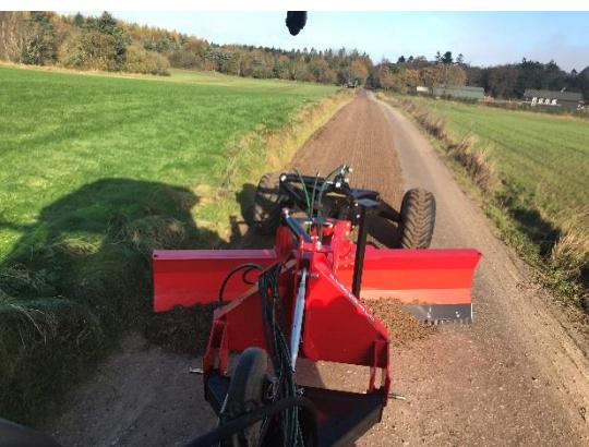
**Der GT-300AUS ist das Topmodell und kann sowohl am Heck- als auch am Front-Dreipunkt-Kraftheber montiert werden.**
