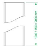
Se recomienda empotrar entre 20 y 40 cm en hormigón, y que sobresalga entre 70 y 160 cm del suelo, según altura de la valla.
