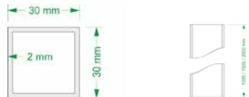
Se recomienda empotrar entre 20 y 40 cm en hormigón, y que sobresalga entre 70 y 160 cm del suelo, según altura de la valla.
