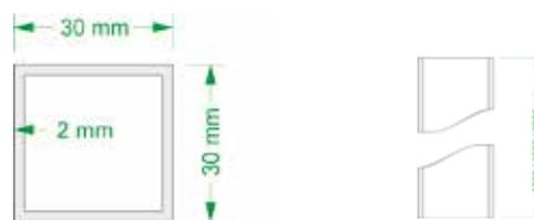
Se recomienda empotrar entre 20 y 40 cm en hormigón, y que sobresalga entre 70 y 160 cm del suelo, según altura de la valla.
