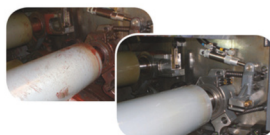
Farbwerk Offset-Druckmaschine vor und nach der Reinigung
