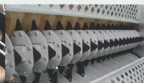
Chaînes à maillons ne nécessitant aucun entretien, avec graissage centralisé, fraises alimentées par convertisseur de fréquence, grille brevetée & contre-lames pour une découpe régulière (brins de 35 ou 69 mm)
