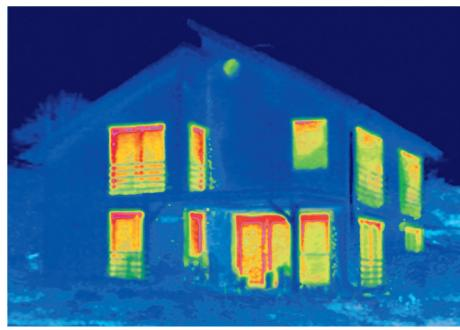
Le immagini a infrarossi e la termografia dimostrano chiaramente in quali punti una casa perde energia incontrollata. Il rosso indica il calore, quindi perdita di energia.
