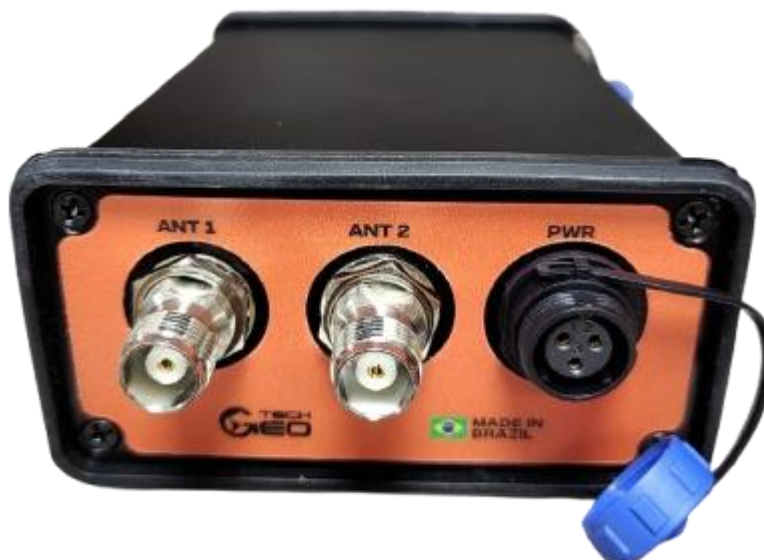
(ENTRADA DAS ANTENAS E FONTE DE ALIMENTAÇÃO)
